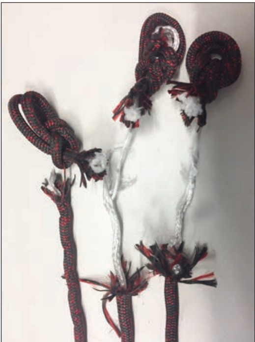
▷&△ Photos 7 et 8 : ruptures de gaines lors du test de traction lente aux nœuds. La gaine cède toujours dans la cravate du nœud supérieur. Photos Florent Merlet. ◁◁ Tableau 2. Code couleur de résistances à la traction lente aux nœuds.
