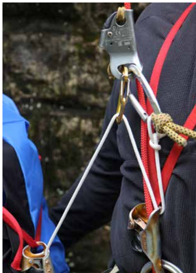
Figure 1. Installation du balancier démultiplié
