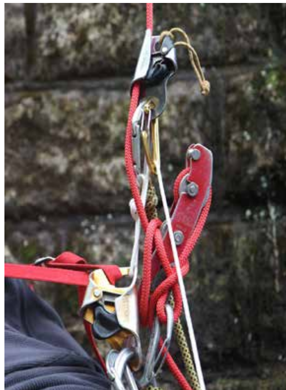
Figure 3. Installation du descendeur avec sa clef complète
