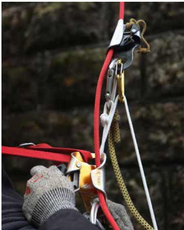
Figure 2. Mise en action du balancier et ouverture du bloqueur ventral de la victime
