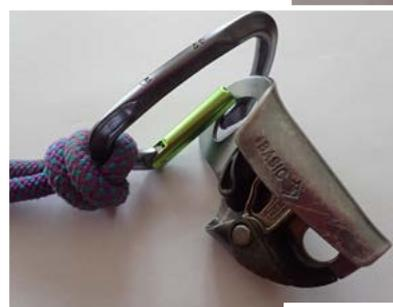
Si on exerce une tension sur la longe vers le bas (chute par exemple), le doigt du mousqueton vient s'appuyer sur le corps du bloqueur et s'ouvre
