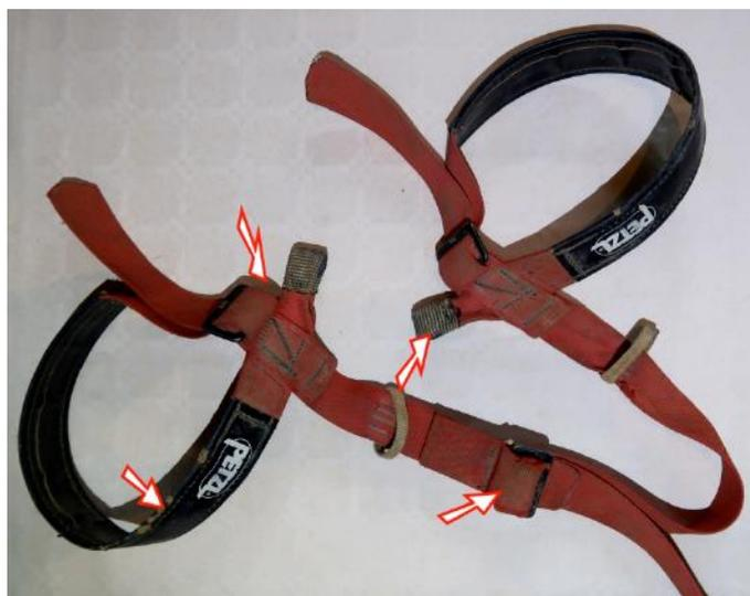
Un point de contrôle inévitable est la sangle qui passe dans la boucle de réglage de la ceinture. Cette boucle métallique peut se situer au milieu du dos ou sur le côté, mais constitue dans tous les cas un élément proéminent particulièrement exposé en méandre ou étroiture.
