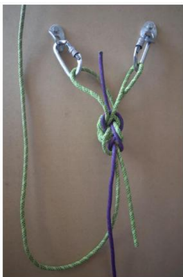
► Figure 5 Nœud de SOA et tressage de corde pour rabouter avec triple huit.
