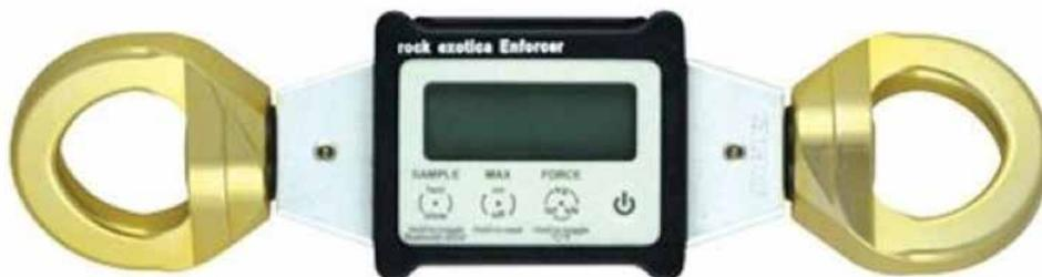
Photo 1 : Dynamomètre (photo site Rock Exotica Enforcer).
