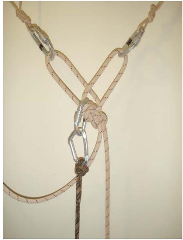
c- Dans certains cas, il n'est pas obligatoire de se longer dans le nœud de chaise double, on peut se longer directement sur les tronçons de la main courante (exemple : sortie de puits,..).
