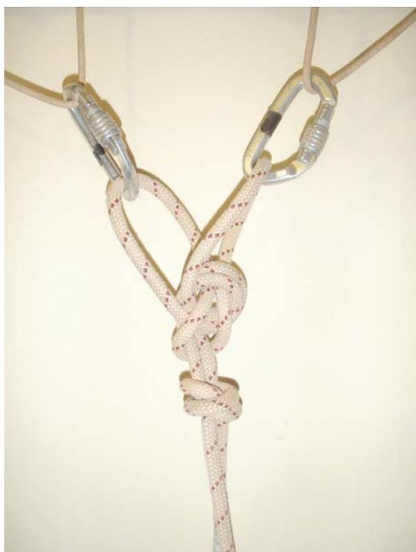
b- De se longer dans les deux ganses du nœud de chaise double lors du passage de fractionnement (photo ci-dessous de gauche). Pour faciliter la manœuvre, il peut être intéressant de positionner un connecteur à vis, sur un amarrage en Y présentant beaucoup d'angle (photo ci-dessous de droite).
