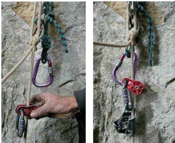
Figure 6 : montage avec bloqueur Basic et poulie Fixe
