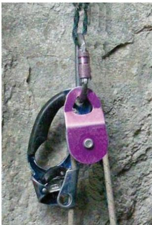
bloqueur est fixé au mousqueton d'attache par sa lumière inférieure. La poulie s'installe par-dessus la poignée dans le mousqueton d'attache. Ceci donne un montage compact et homogène.
