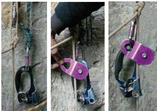
Figure 7 : montage avec bloqueur poignée et poulie Rescue
