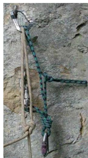
La chaîne de mousquetons peut être remplacée par un anneau de cordelette ou de sangle monté en répartiteur dans le ou les amarrages, et bloqué par un nœud (huit ou vache) (figure 5). Ceci donne une meilleure maniabilité au mousqueton d'accroche, alors qu'une chaîne de mousquetons travaille souvent mal.
