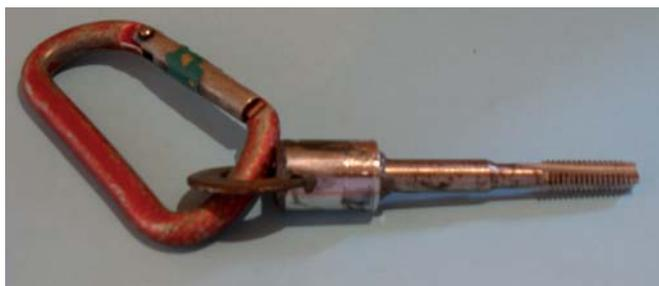
Figure 6 : le taraud monté sur un carré de douille de clé à cliquet
