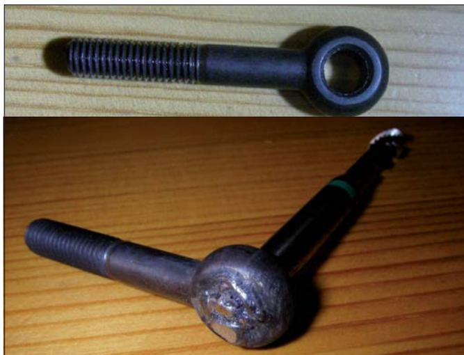
Figure 4 : la vis d'articulation NORELEM (au-dessus) et l'ensemble taraud + vis d'articulation soudé
