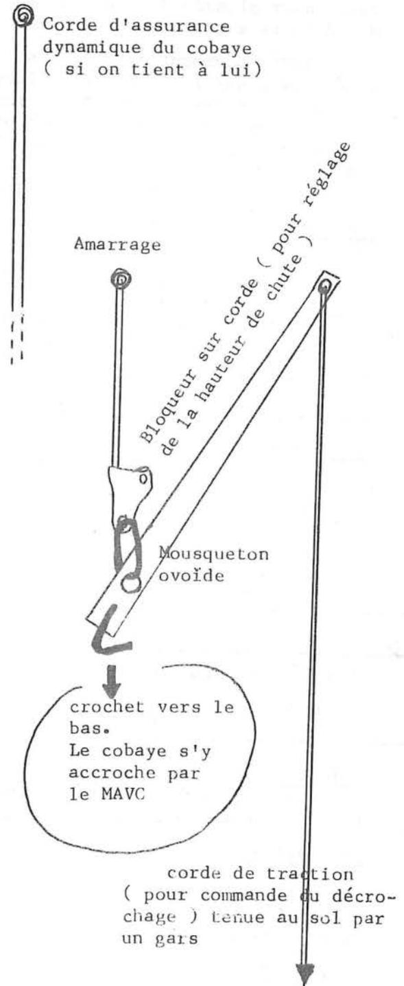
pour cette partie, j'ai personnellement utilisé une boucle de baudrier, coupée et boulonnée. Ce qui évite d'avoir à faire une soudure. Fait en  $\frac{1}{2}$  h avec une perceuse d'amateur et 2 mèches (12 & 6 mm)
